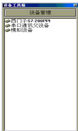
双击“设备工具箱”中的“串口通讯父设备”，再双击“西门子 S7-200PPI”，如图：
