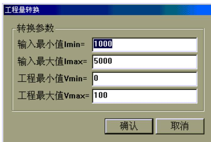
MCGS 在运行环境中则根据输入信号的大小采用线性插值方法转换成工程物理量（0 - 100RH）范围。
