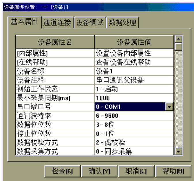
计算机串行口是计算机和其它设备通讯时最常用的一种通讯接口，一个串行口可以挂接多个通讯设备（如一个 RS485 总线上可挂接 255 个 ADAM 通讯模块，但它们共用一个串口父设备），为适应计算机串行口的多种操作方式，MCGS 组态软件采用在串口通讯父设备下挂接多个通讯子设备的一种通讯设备处理机制，各个子设备继承一些父设备的公有属性，同时又具有自己的私有属性。在实际操作时，MCGS 提供一个串口通讯父设备构件和多个通讯子设备构件，串口通讯父设备构件完成对串口的基本操作和参数设置，通讯子设备构件则为串行口实际挂接设备的驱动程序。
